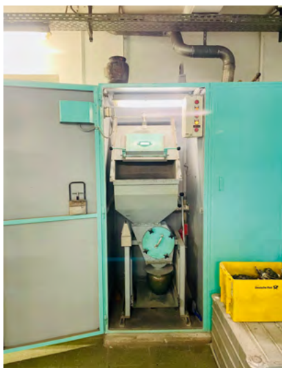
Nach dem Verbrennungsprozess werden die verbliebenen Knochenteile in dieser Mühle fein zermahlen und in eine biologisch abbaubare Kapsel abgefüllt.
